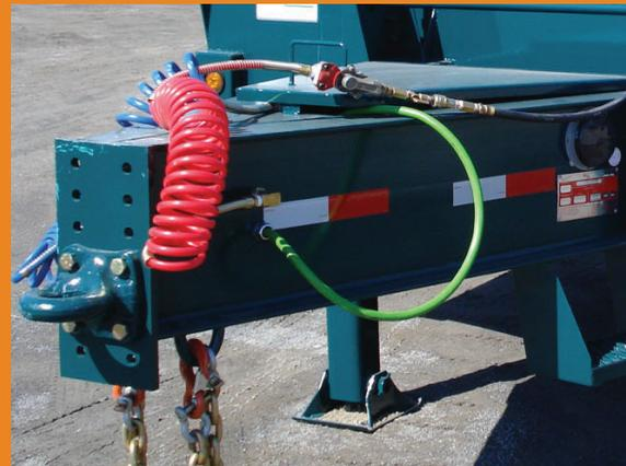
Attachement sur oeil de 3" ajustable avec coffre
