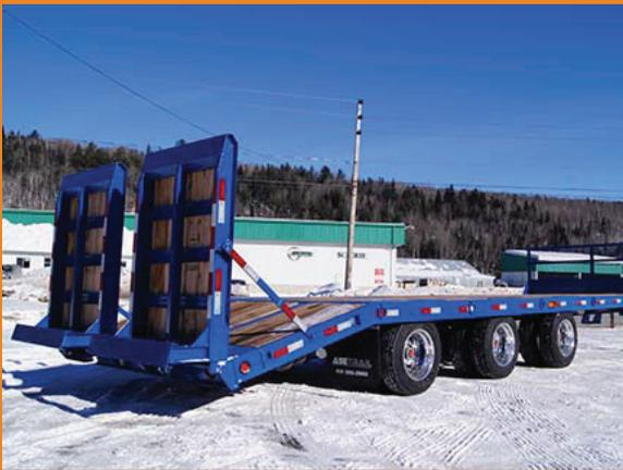
Rampes a ressort, air et hydraulique
